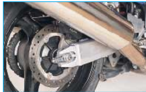
Honda führt das Rad mittels solider Alu-Kastenschwinge. Nur die Kettenspanner wissen nicht recht zu gefallen.
