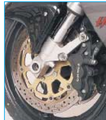
Serienmäßiges ABS an der BMW, aber Nachgreifen und hohe Handkräfte erforderlich (ganz o.). Perfekte Honda-Bremsen mit CBS (M.) und Suzukis Sechskolben-Stopper, die etwas besser dosierbar sein könnten.
