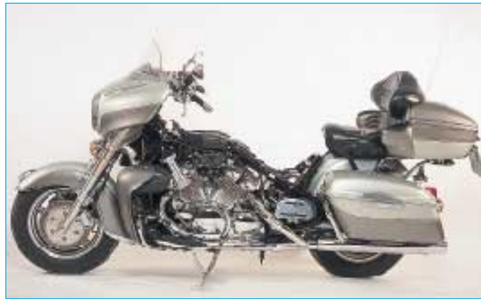
Yamahas V4 samt kräftigem Rückgrat (o.). Der Motorhaltebügel erschwert den Check der vorderen Kerzen (l.). Ventil für die luftunterstützte Gabel (u.). Batterie, Benzinpumpe und Sicherungen liegen unter Fahrersitz und linkem Seitendeckel.
