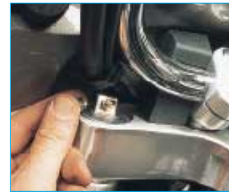
Yamahas V4 samt kräftigem Rückgrat (o.). Der Motorhaltebügel erschwert den Check der vorderen Kerzen (l.). Ventil für die luftunterstützte Gabel (u.). Batterie, Benzinpumpe und Sicherungen liegen unter Fahrersitz und linkem Seitendeckel.
