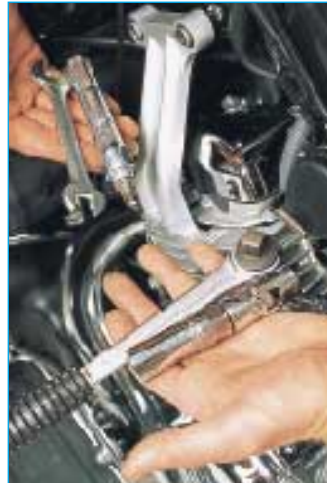
Yamahas V4 samt kräftigem Rückgrat (o.). Der Motorhaltebügel erschwert den Check der vorderen Kerzen (l.). Ventil für die luftunterstützte Gabel (u.). Batterie, Benzinpumpe und Sicherungen liegen unter Fahrersitz und linkem Seitendeckel.
