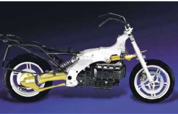
Der BMW-Vierzylinder hängt in einem unten offenen Aluminium-Brückenrahmen.
