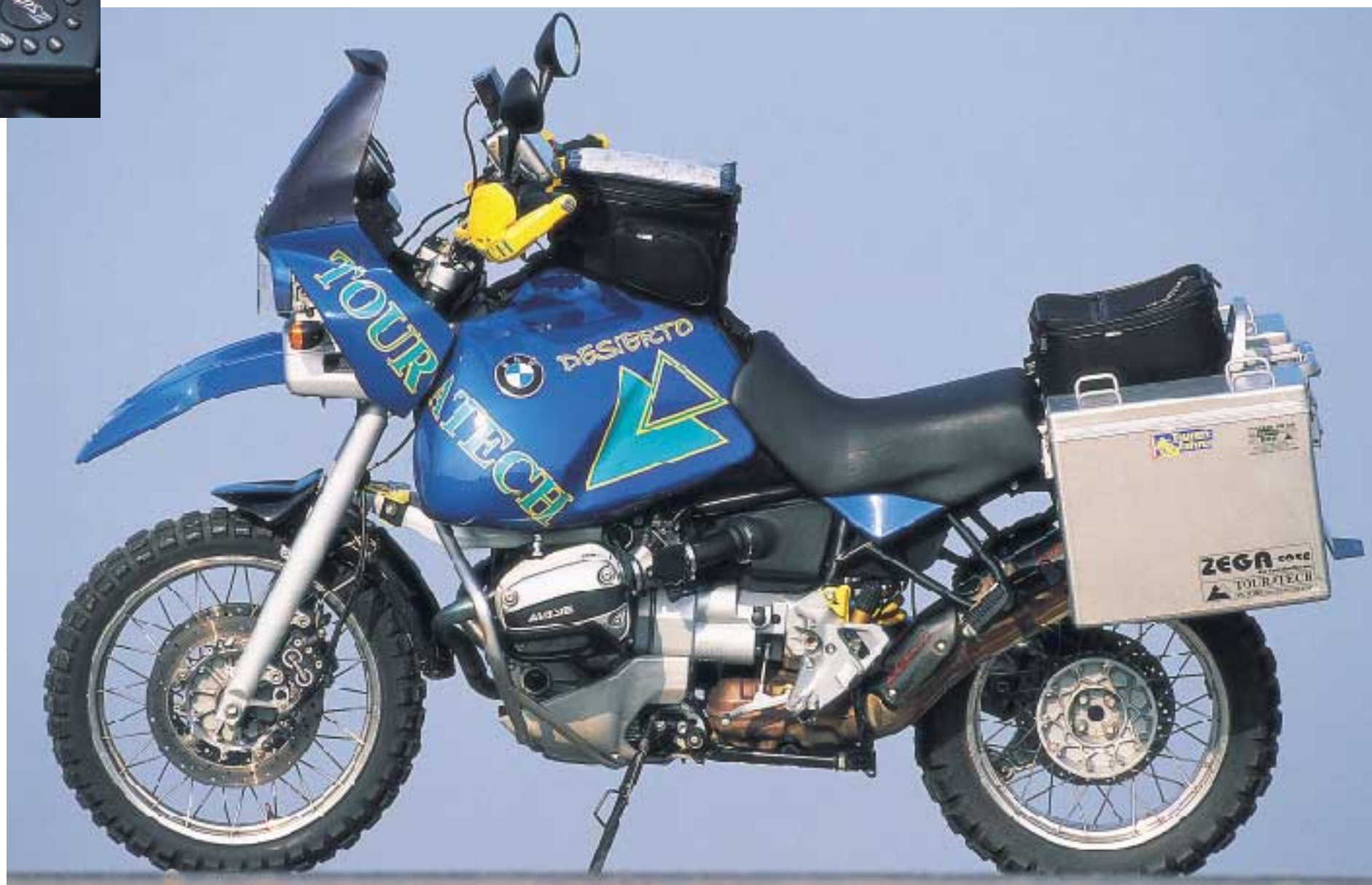
Ein massiver, sechsfach verschraubter Sturzbügel und eine am Ständer befestigte Alu-Platte schützen den Motor umfassend (ganz l.). Carbon-Blendfrischen die Optik des Serienauspuffs auf.
