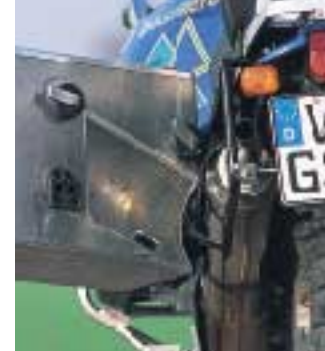
Hecktasche für die kleine Tour oder Zega-Boxen für die große. Das Sondersystem der Alu-Boxen schmiegt sich dank Aussparung eng ans Fahrzeugheck an.
