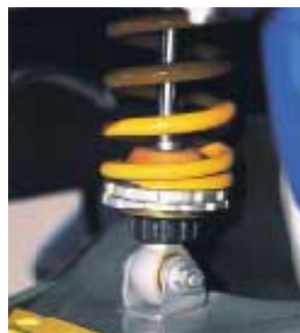
Voll die Härte: Stahlflexleitungen sorgen für harten Druckpunkt, das am Längslenker montierte Hard-Part LA (oben) beugt beim Sturz einem Abbrechen des Lenkanschlags vor. Auch das Fahrwerk ist nichts für Softies. Sündhaft teure Ölhlins-Komponenten ersetzen die Serienfederbeine (rechts).
