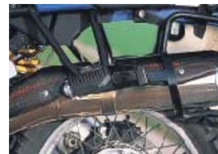
Ein massiver, sechsfach verschraubter Sturzbügel und eine am Ständer befestigte Alu-Platte schützen den Motor umfassend (ganz l.). Carbon-Blendfrischen die Optik des Serienauspuffs auf.
