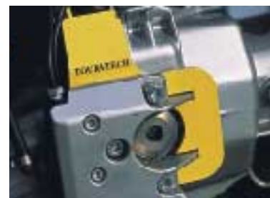
Noch ein Hard-Part: Dieses gelbe Teil (o.) verstärkt Heck- und Fußrastenaufnahme.
