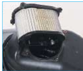
Airbox samt Filterelement sind unter dem Tank platziert (oben), das Bordwerkzeug unter der Sitzbank. Das Sortiment ist zwar reichhaltig, aber von der üblichen japanischen Qualität. Zur Kerzenkontrolle reicht es allemal.
