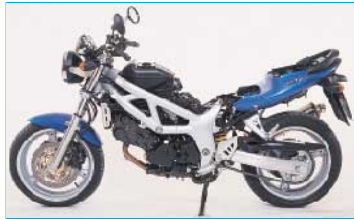
Suzukis 90-Grad-V wird vom dicken Alu-Gitter umschlossen. Der vordere Zylinder ist gut zugänglich, um an den hinteren zu gelangen, muß der Tank fallen.
