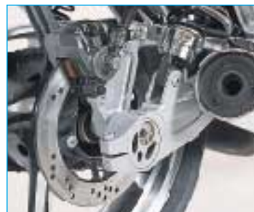
Schön gezeichnete Instrumente lassen die klöbigen Armaturen verschmerzen (ganz links). Funktional und schön zugleich: Mit diesen Exzentern macht selbst das Kettenspannen Spaß.
