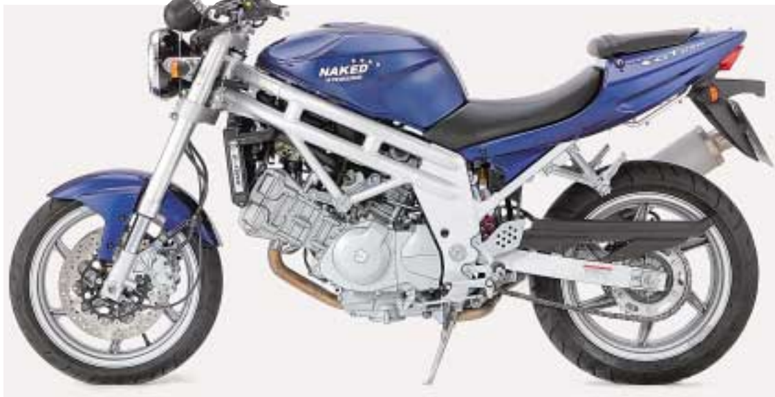
Elegante Erscheinung: Optisch macht die Hyosung eine Menge her, der Rahmen ist allerdings nicht aus Aluminium, sondern aus Stahl gefertigt.
