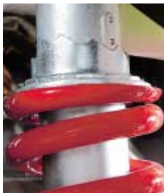
Das hintere Federbein der Hyosung ging im Test kaputt.
