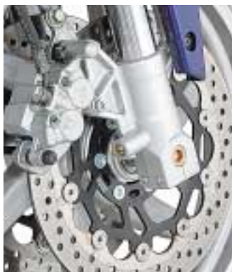
Aufwendig, aber nicht perfekt: Doppelkolbenbremsen an der GT.
