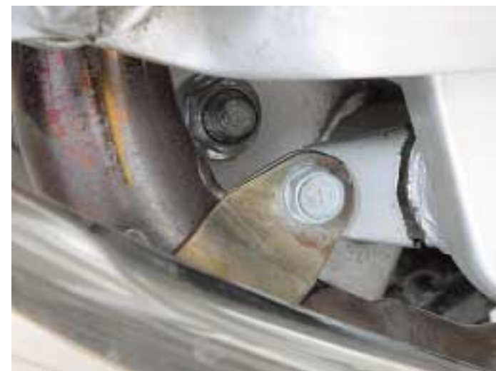
Peinlich: Gleich bei Testbeginn ist die Auspuffhalterung der GT gerissen.
