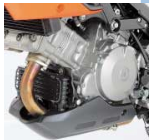
Tief liegender Ölkühler, solider Kettenspann-Mechanismus, Handrad zur Einstellung der Federbasis am Zentralfederbein (oben).
