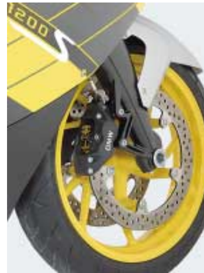
Das BMW-typische Teilintegralbremssystem ist in der K 1200 S nicht so bissig abgestimmt und deshalb besser zu dosieren.
