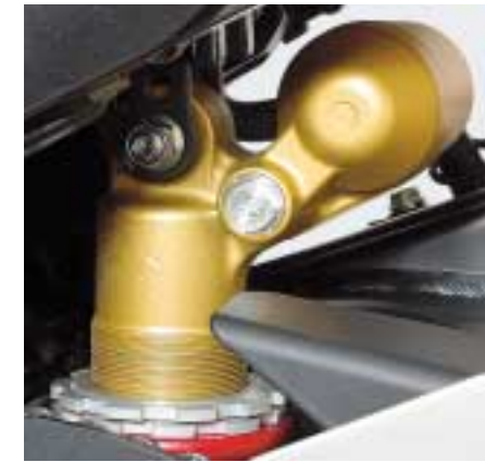
Die Einstellung der Federvorspannung entpuppt sich an der Kawasaki als recht aufwendige Sache.
