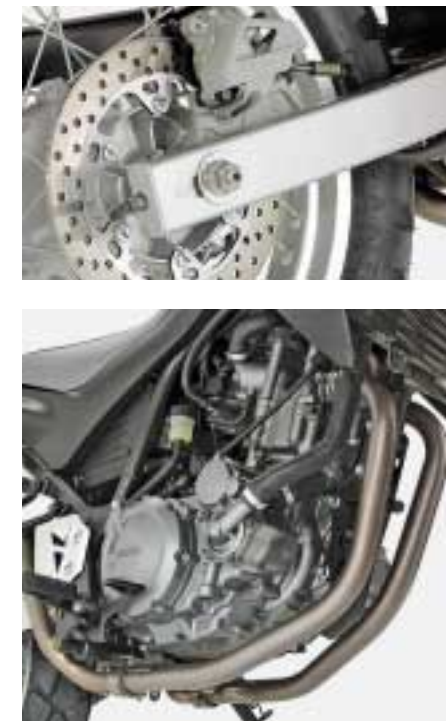
Schmale Taille und wirksame Hinterrad- bremse an der XT 660 R. Die Krümmerrohre verlaufen ungeschützt unter dem Motor.
