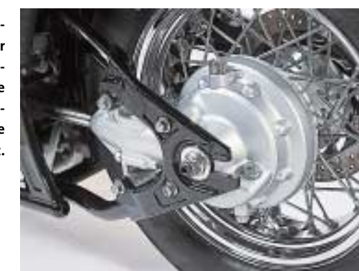
An der Achsaufnahme der lackierten Dreieckschwinge ist beim Radausbau schnell die Farbe lädiert.
