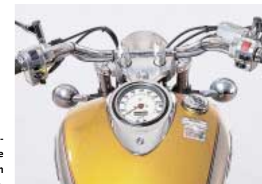
Große Tankkonsole, keine zusätzlichen Instrumente.
