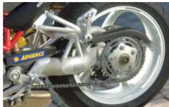
Die Einarmschwinge ist leichter als das Vorgängermodell, die Fünf-Speichen-Räder kommen von Marchesini.
