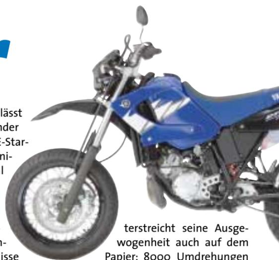
terstreicht seine Ausgewogenheit auch auf dem Papier: 8000 Umdrehungen genügen, um alle 15 Pferde auf den Plan zu rufen. Kernige Zweitakt-PS, die in Verbindung mit dem geringen Gewicht – die 125er wiegt gerade mal 134 Kilogramm – für durchaus sehenswerte Fahrleistungen sorgen. Wie bei Zweitakt-Motoren üblich wird die Sechsgang-Schaltbox häufig frequentiert. Schade nur, dass die Endübersetzung et-
