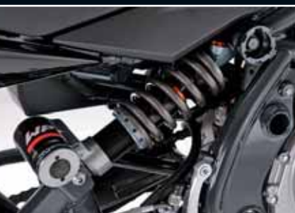
Digitaltuning per Power-Commander (g.o.). Höhenverstellbares WP-Supercompetition-Federbein (o.).
