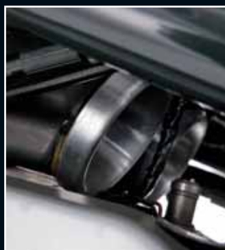
Lautatmer: Die fast offenen Ansaugsnorcher sind nicht TÜV-conform. Eine Lösung wird gesucht.
