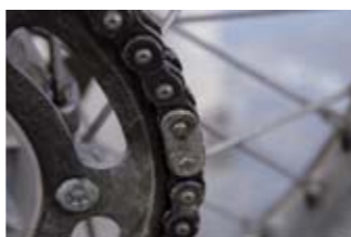
Notdürftig geflickte Antriebskette, der bei Kilometerstand 2235 ein Stein in die Quere kam.
