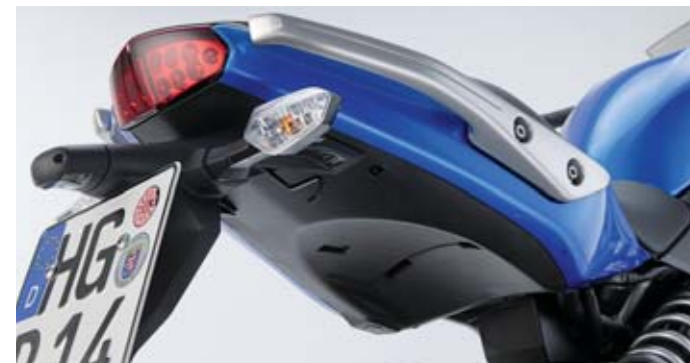
Alu statt Kunststoff für die Sozius-Haltegriffe. Sieht nicht nur gut aus, sie sind jetzt auch niedriger angebracht und lassen sich besser greifen.
