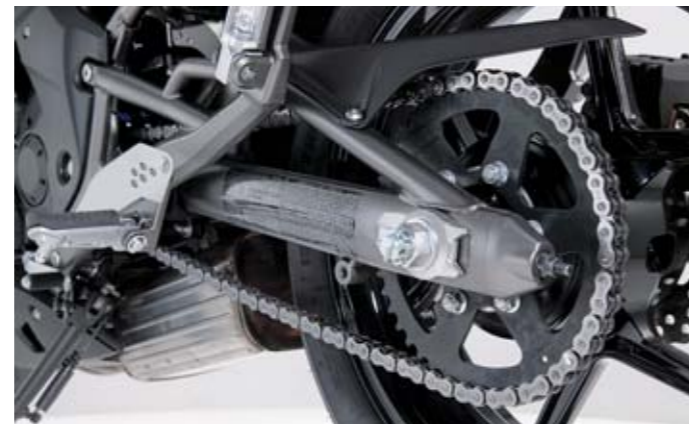
Schwinge nun im D-Profil statt ovalem Querschnitt. Die Kettenspanner sind ansehnlicher geworden, die Rastenausleger ebenfalls.
