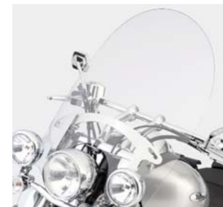
Windschilde hält der Triumph-Händler in drei verschiedenen Größen bereit, jedes mit Schnellverschlüssen für eine flotte Demontage.
