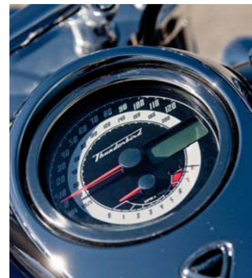
Das LCD-Display für Kilometerstände, Reichweite und Uhrzeit wird vom Lenker aus bedient. Die Kombination aus mph- und km/h-Skalen verwirrt.
