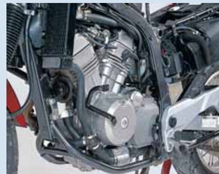
Bei demontiertem Motorschutz (hier die XL 650 V) lassen sich Wasserpumpe (unten) und -schläuche auf Undichtigkeit prüfen.
