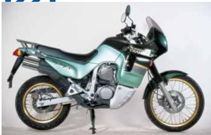
Die Bremsstrommel im Hinterrad weicht einer 240-mm-Bremsscheibe mit Einkolben-Schwimm-sattel, der Preis steigt auf 10.850 DM (5.547 Euro).
