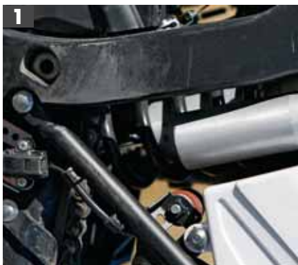
1 Der Alu-Rahmen verliert im sensiblen Schubbereich schnell an Farbe – der Heckrahmen ist geschraubt. 2 Die WR ist deutlich sportiver, baut höher und bietet mehr Bodenfreiheit. 3 Professionell gestalteter Ausgleichsbehälter der Hinterradbremse. 4 Ordentliche Klemmung und vielfach einstellbare Upside-down-Gabel vorn. 5 Breite und grob gezackte Fußrasten gibt es ab Werk – Gehäusedeckel mit einer Kunststoff-Abdeckung! 6 Kurze Rast am Col d'Izoard.
