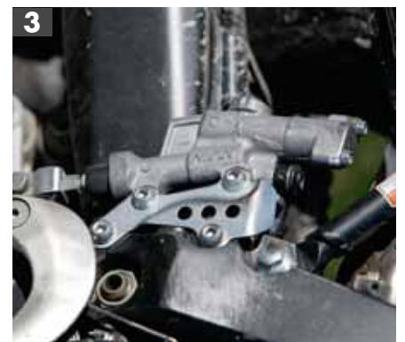
1 Der Alu-Rahmen verliert im sensiblen Schubbereich schnell an Farbe – der Heckrahmen ist geschraubt. 2 Die WR ist deutlich sportiver, baut höher und bietet mehr Bodenfreiheit. 3 Professionell gestalteter Ausgleichsbehälter der Hinterradbremse. 4 Ordentliche Klemmung und vielfach einstellbare Upside-down-Gabel vorn. 5 Breite und grob gezackte Fußrasten gibt es ab Werk – Gehäusedeckel mit einer Kunststoff-Abdeckung! 6 Kurze Rast am Col d'Izoard.
