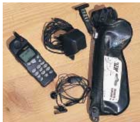
Oben: Ohrhörer mit Hochleistungsmikrofon und federbelastetem Clip. Links: Das Nokia-Set ist 38 Gramm schwerer als das Siemens-Pendant.
