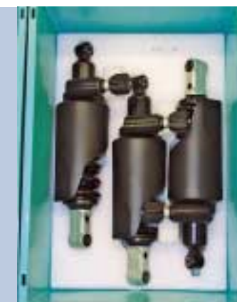
In Transportkisten mit vorgeformter Schaumfüllung gehen die Fahrwerksteile auf den Weg zur Montage im BMW-Werk Berlin.
