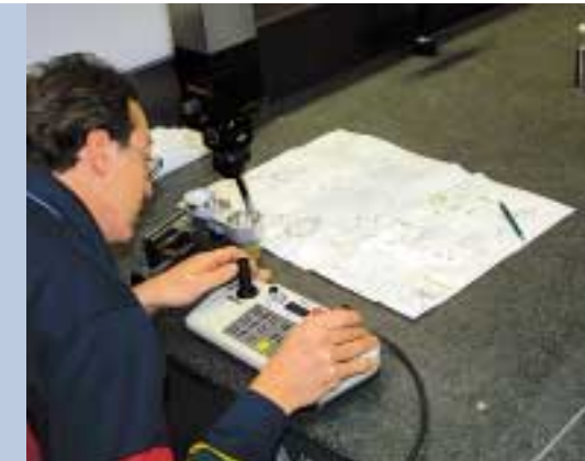
Bevor es losgeht, werden die von Zulieferern angefertigten Komponenten in der strengen Qualitätskontrolle auf Maßhaltigkeit und Fehler geprüft, je nach Bauteil in unterschiedlicher Stichprobenfrequenz.
