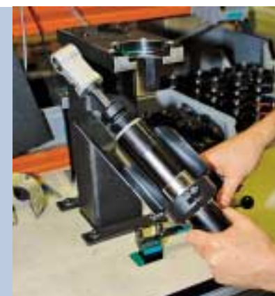
Nämlich hier. Der Federeinsteller mit Handrad und der Schmutzfänger aus Kunststoff werden zusammen am Dämpfergehäuse angebracht, die Feder kann kommen.
