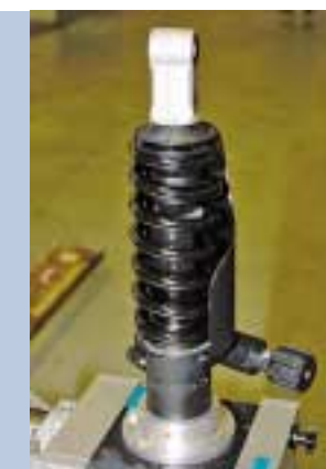
Die Feder wird aufgeschoben, maschinell vorgespannt, dann werden die Federteller eingesetzt. Fertig ist das Federbein.
