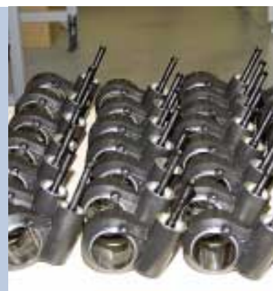
Dies sind die Einheiten zur Einstellung der Federvorspannung. Sie werden an einer anderen Stelle der Montage vormontiert und gleich verbaut.
