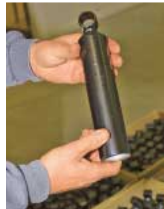
Dies ist eine so genannte »Tube«, also ein Dämpfer-Gehäuse, im Wareneingang. Die Tubes werden so vorgefertigt angeliefert.
