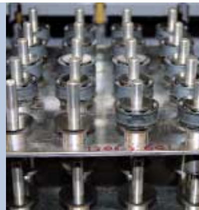
Dämpfer-Einheit und Kolbenstange werden im Werk von Hand montiert. Dabei ist Vorsicht geboten, die Dämpfer-Plättchen sind nur 0,1 mm dünn.
