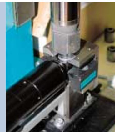
Hier entsteht das »Dämpfer-Auge«, also das Befestigungslager für die spätere Verschraubung im Fahrzeugrahmen. Es wird maschinell eingepresst.
