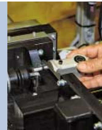
So wie etwa beim oberen Ende des Federbeins. Dieses Alu-Gussteil wird hier mit der 14 Millimeter starken Dämpferstange verschraubt.
