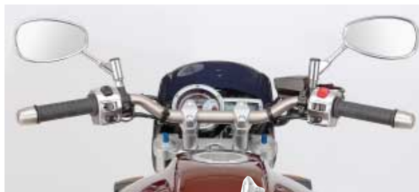
Schwer ablesbare Instrumente mit toller Optik (ganz o.), von 14 auf 15 Millimeter vergrößerter Hauptbremszylinder (o. links). Neu: Gabelbrücke, Klemmböcke und Lenker.
