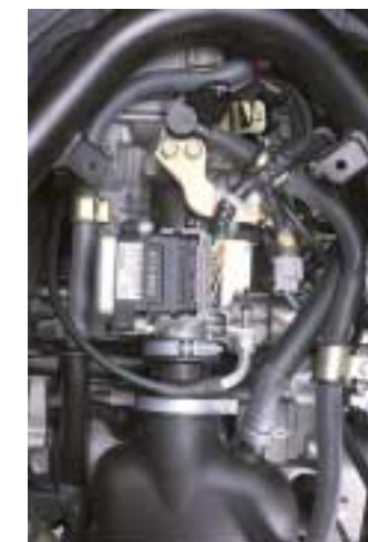
Dank kompakter Einspritz- und G-Kat-Technik (rechts) ist der neue SH 125 i der erste Roller weltweit, der die ab 2006 gültige Euro 3 erfüllt (oben).
