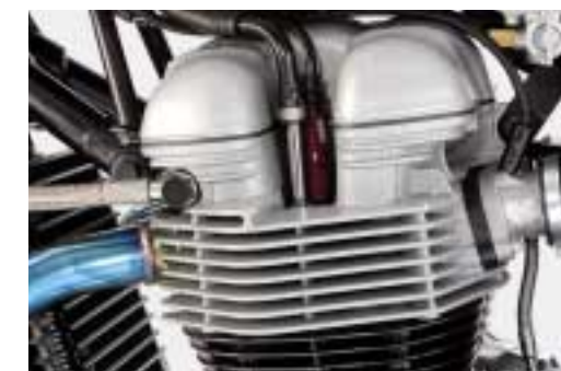
Ebenfalls modern: Sekundärluftzuführung auf Höhe der mittig platzierten Zündkerze.
