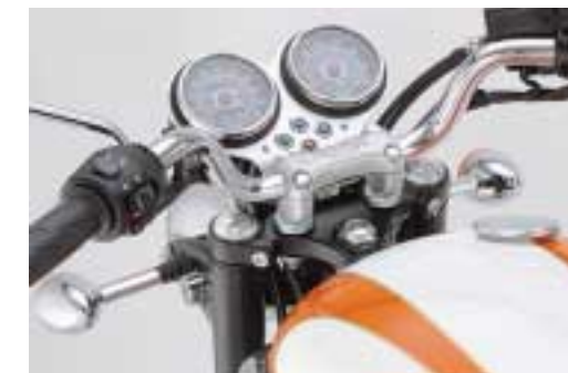
Die Bonneville Baujahr 2005 hat zwei Rundinstrumente und vier Kontrollleuchten, die Lenkerklemmung mit Triumph-Schriftzug zeugt von viel Liebe zum Detail.
