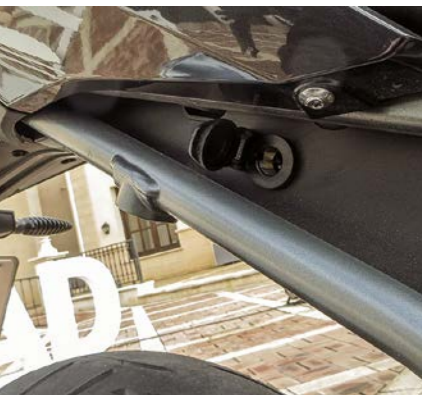
Auch die neue „R“ hat eine Bordsteckdose serienmäßig (o. li.). Das Staufach unterm Soziuspolester bietet Platz für Erste-Hilfe-Set und Warnweste (o.). Die weiße Feder des optionalen Dynamic ESA (re.).
