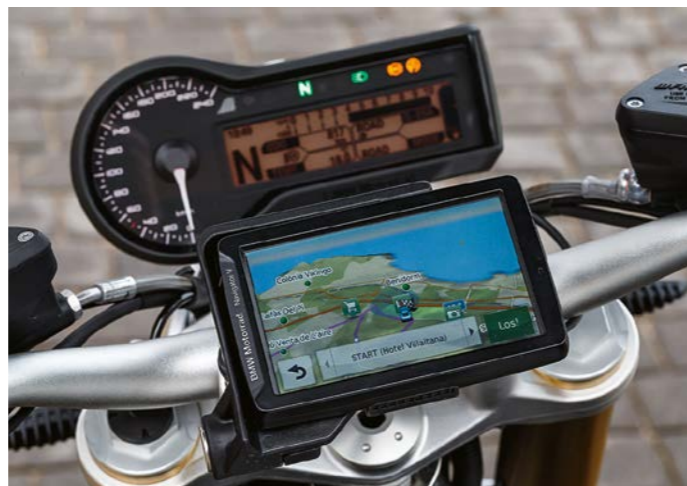
Alles im Blick: Im linken Gabelholm die elektronisch regelnde Hydraulik-einheit. Zentral platziert, BMW-Navi und Cockpit mit TFT-Display.
