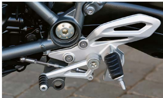
Option Schaltassistent Pro: Rauf- und Runterschalten ohne Kupplungsaktivierung ist auch für Landstraßenfahrer ein echter Gewinn an Komfort und Fahrspaß (rechts oben).
